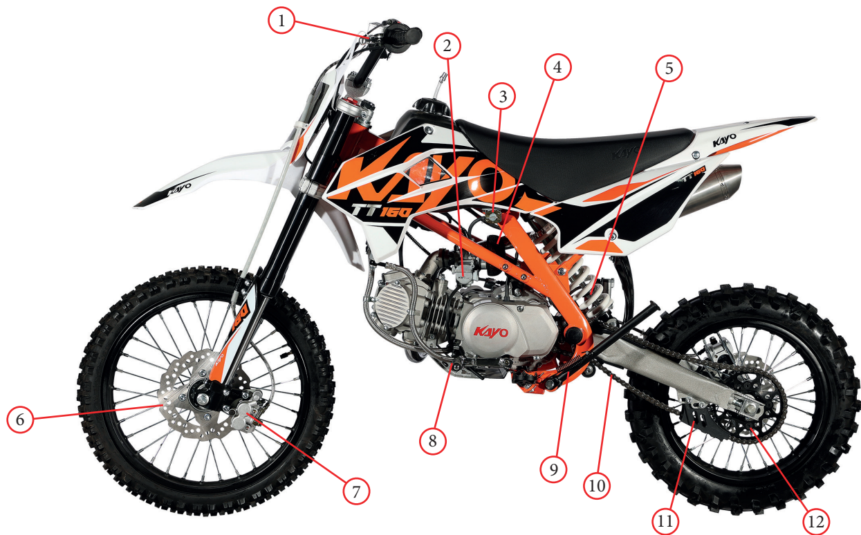
Фото 2.1 Левая сторона питбайка: 1 – рычаг сцепления; 2 – карбюратор; 3 – топливный кран; 4 – воздушный фильтр; 5 – задний амортизатор; 6 – передний тормозной диск; 7 – передний тормозной суппорт; 8 – рычаг переключения передач; 9 – боковая подставка; 10 – приводная цепь; 11 – слайдер-уловитель цепи; 12 – задняя звездочка
